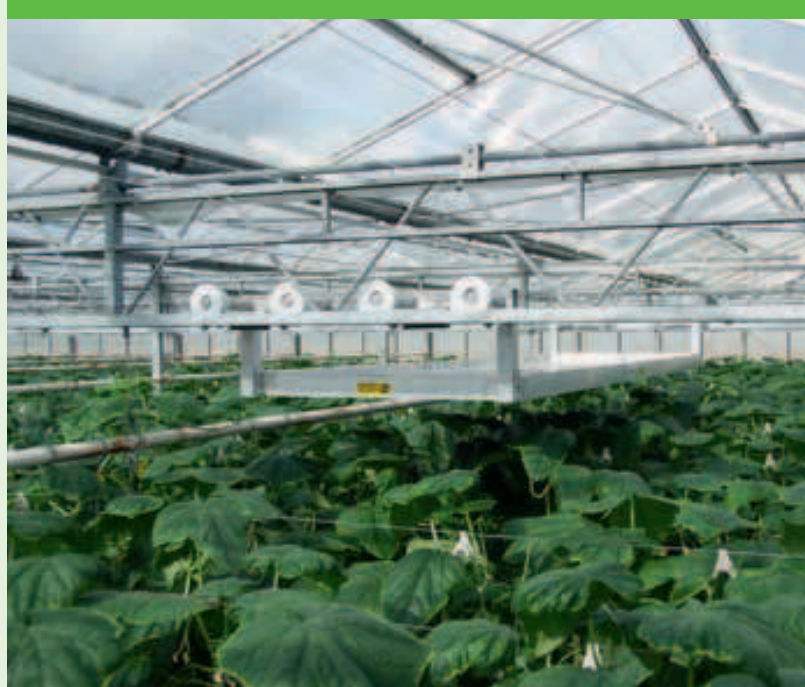
De overgewaswagen in de oude lage kas bij Van Dijk; in een nieuwe kas is veel meer ruimte boven het gewas.
