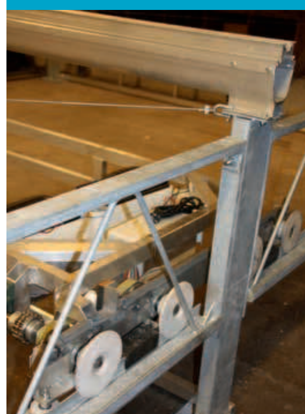
De Klimrek spantrail heeft een U-profiel als onderligger. Bij de paal zit een uitsparing, zodat de overgewaswagen kan passeren.
